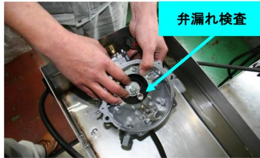
特殊溶液に浸漬させ弁漏れ検査
