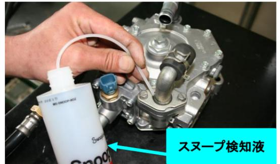
検知液を使用して気密検査
